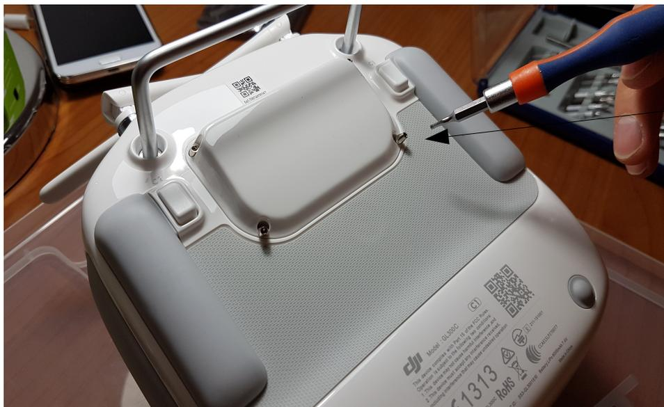
Con un cacciavite per chiavi a brugola smontare il coperchio in plastica del modulo
