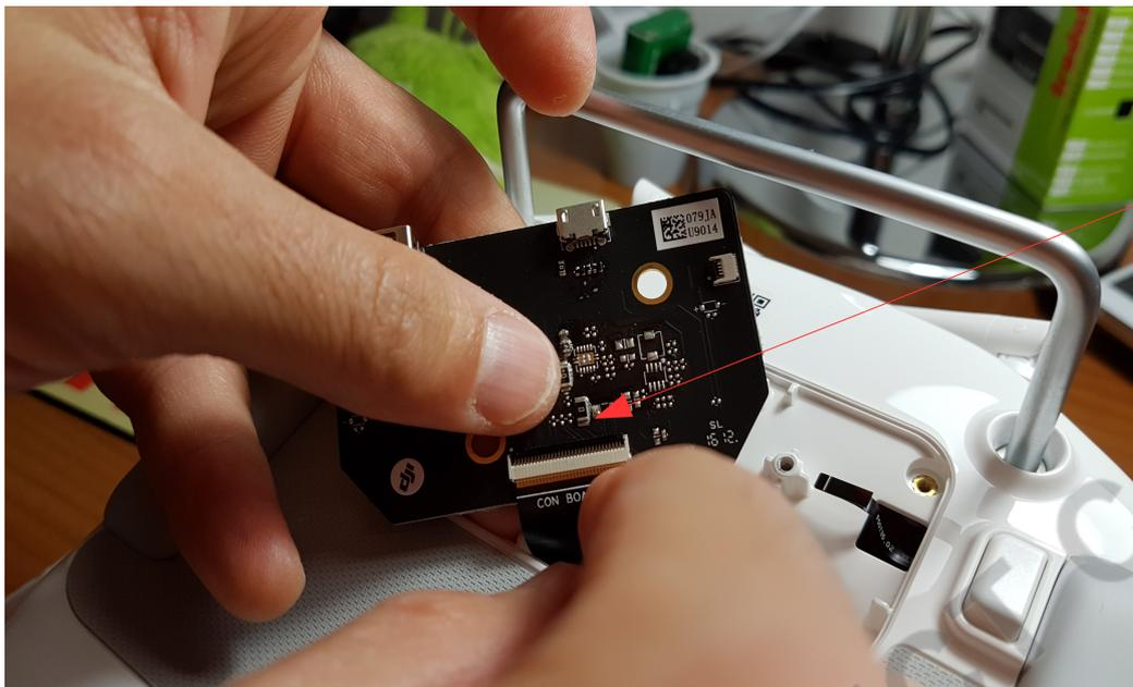
Alzare la clip nera che blocca il cavo flat principale: va sollevata con l'unghia.. in pratica dalla posizione parallela alla scheda va messa a 90 gradi perpendicolare alla stessa.
